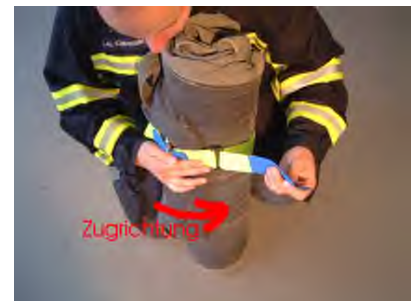
Den Roll-fix gemäss Bild montieren. Richtig montiert, zieht sich der s-2-s zusammen.
